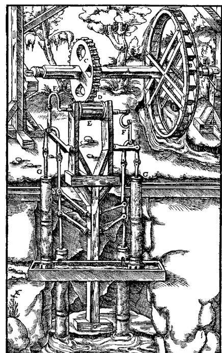
Die obere Welle A. Das Wasserrad, das durch das Bachwasser getrieben wird. B.
